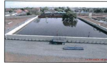
รูปที่ 6 : การทดสอบกำแพงป้องกันน้ำท่วม
